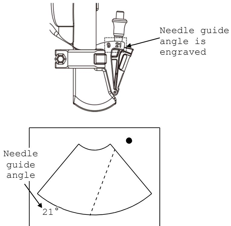
Fig. 3 Needle guide angle
